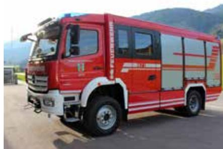
▲ HLF 2 mit 2.500 Liter Löschwasser, 140 Liter Schaummittel, Wasserwerfer, Seilwinde und akkubetriebenes Rettungsgerät der FF Aich
