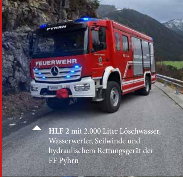
▲ HLF 2 mit 2.000 Liter Löschwasser, Wasserwerfer, Seilwinde und hydraulischem Rettungsgerät der FF Pyhrn
